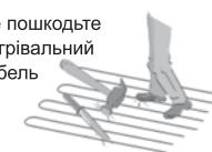
Перевірте цілісність кабелю перед заливанням бетону
